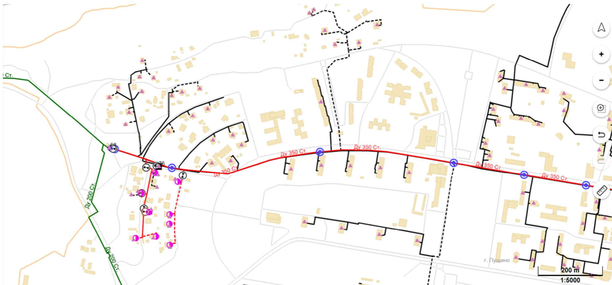
Рисунок 3.9 – Схема газопроводов низкого давления на территории г.о Пушкино (часть 2)
