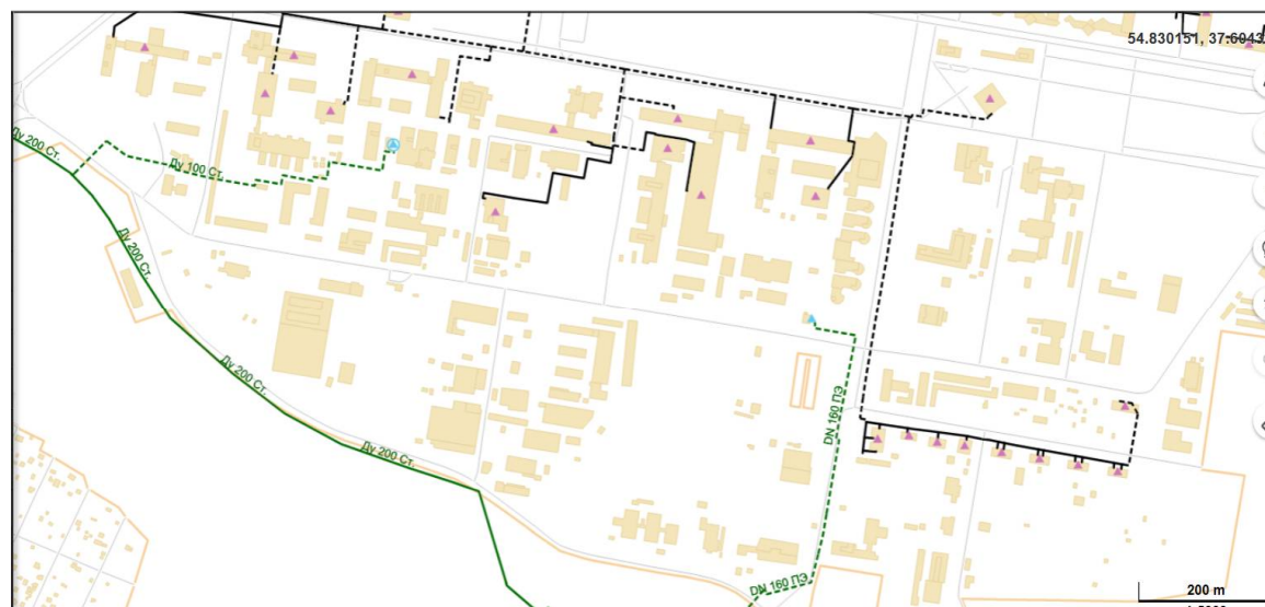
Рисунок 3.8 – Схема газопроводов низкого давления на территории г.о Пущино (часть 1)
